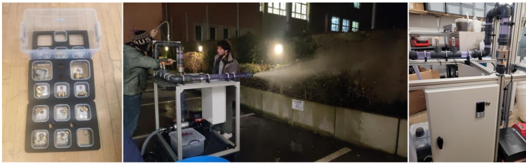
Abbildung 15: Düsen (links), Inbetriebnahme des Versuchsstandes (Mitte) und Ansicht Versuchsstand (rechts)
